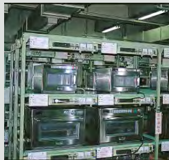
Dlhodobá skúška pri prerušovanej prevádzke** Zapnúť (60 s) a vypnúť (30 s), 200.000-krát; Zapnúť (20 s) a vypnúť (10 s), 200.000-krát
