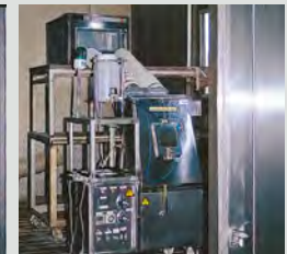
Prašný a parný test** Prevádzka v prachu a pri pare pri teplote +40 °C a relatívnej vlhkosti vzduchu 95 %
