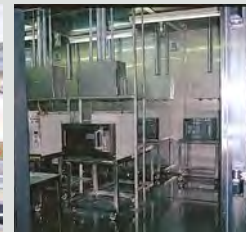
Kombinovaný záťažový test** Teplota od 0 °C do +40 °C, relatívna vlhkosť vzduchu 85 %
