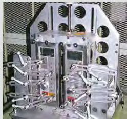
Dlhodobá skúška ovládacieho poľa** 200.000-násobné stlačenie tlačidlových polí
