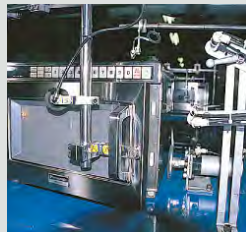
Dlhodobá skúška dvierok (otváranie a zatváranie)** 400.000-násobné otvorenie a zatvorenie dvierok
